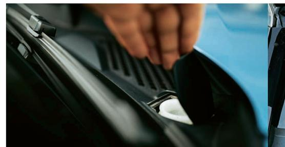
**Nur mit Trichter: Der Wischwasserstutzen sitzt unter der Frontscheibe. Elektrischer Ladeodosendeckel**
