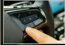
Rechts am Lenkrad steuert man über Tasten Bordcomputer und Audiosystem, links die Temporegelanlage
