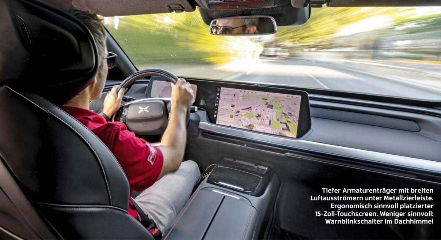
**Tiefer Armaturenräger mit breiten Luftausströmern unter Metallzierleiste. Ergonomisch sinnvoll platzierter 15-Zoll-Touchscreen. Weniger sinnvoll: Warnblinkschalter im Dachhimmel**
